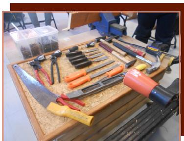
Un établi, c'est un plan de travail avec un étau et un serre-joint, des marteaux dont un marteau avec un pied de biche pour retirer les clous, des tournevis cruciformes, des râpes rondes, plates et des râpes en demi cercle, des pinces, des tenailles, des vis et des clous.
